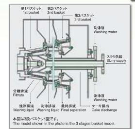
連続式であることからプロセ スの簡略化、設備及びラン ニングコストの低減が可能 となり、機械振動小、据付面 積小、消費電力小、据付簡 単、操作簡単、保守·点検簡 単、しかも小型で処理能力 は大です。
